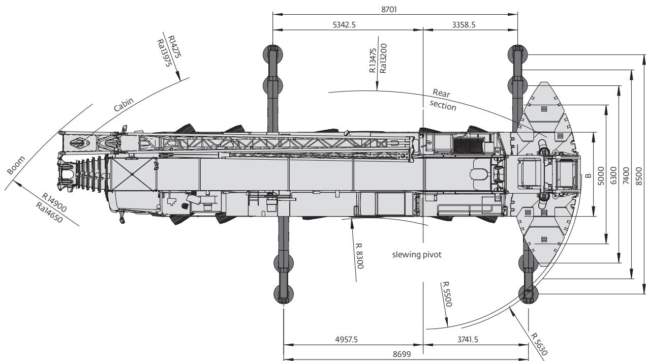
*Ra = Radius all wheels steered. • Radius allradgelenkt. • Rayon toutes les roues directrices. • Radio de giro con todas las ruedas giradas. • Raggio di curva con tutte le ruote sterzate. • Радиус поворота при управлении всеми колесами.*
