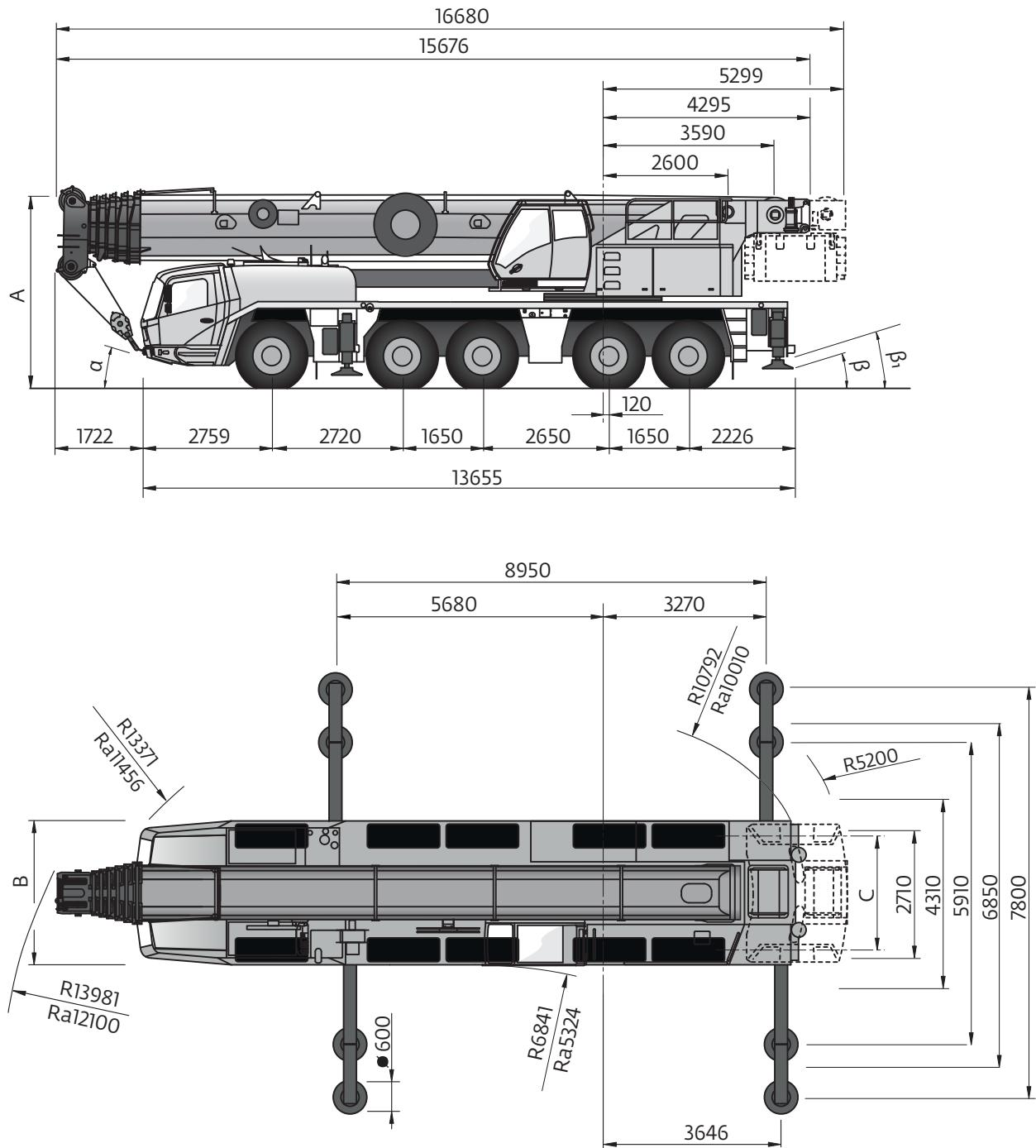
Ra = Radius all wheels steered. • Radius allradgelenkt. • Rayon toutes les roues directrices. • Radio de giro con todas las ruedas giradas. • Raggio di curva con tutte le ruote sterzate.
