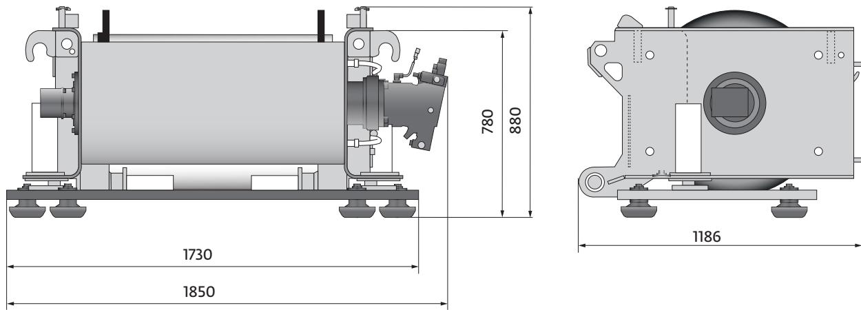
Hose reel • Schlauchtrommel • Enrouleur • Bobina de manguera • Avvolgitubo • Барабан лебедки
